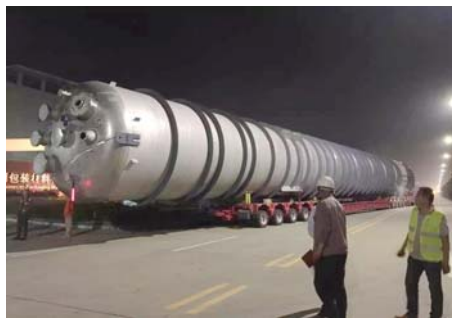
图为重达 220 吨的陆上“巨无霸”反应器运抵安装现场
